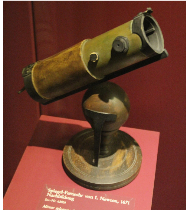
Figura 10 - Réplica do primeiro telescópio refletor, construído por Isaac Newton, em exposição no Deutsches Museum, em Munique. Foto: Francisco Conte.
