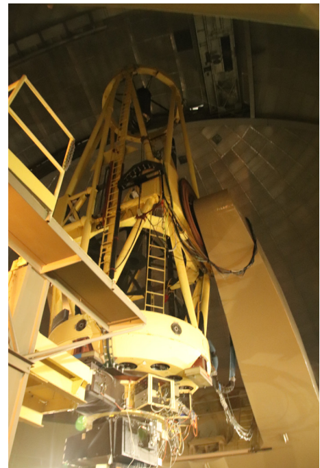
Figuras 85 e 86 - Vistas externa e interna do telescópio Shane, do observatório Lick. O maior telescópio construído no mundo nas décadas de 1950 e 60, utilizando um espelho de teste feito para o Hale em Monte Palomar. Fotos: Francisco Conte.
