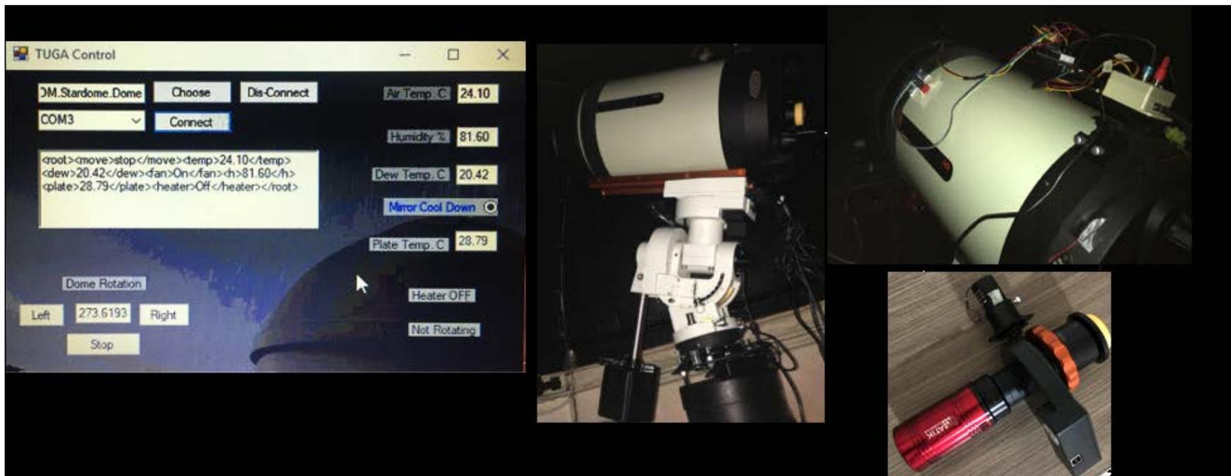
*Figura 1. Esquerda: TUGA Control – software de controle desenvolvido para melhorar a performance do sistema óptico. Centro: montagem iOptron CEM-60. Direita: detalhe do hardware de controle de temperatura baseado em Arduino e câmera CCD ATIK 414Ex.*
