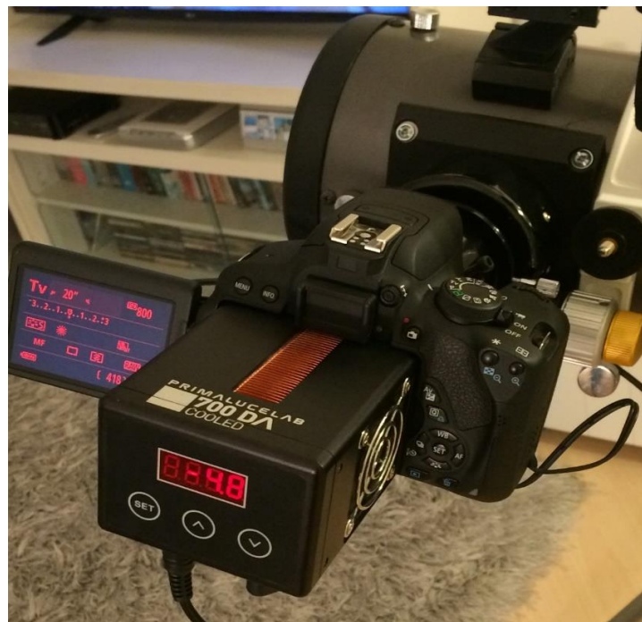
Canon 700D com sistema de refrigeração. Aqui o sensor estava quase a 5 graus Celsius negativos.
