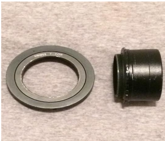
Anel T2 à esquerda e adaptador T2 à direita
